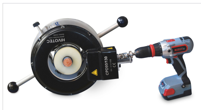
Hivotec Unipower 34R motordrift for CP90 og CP130
